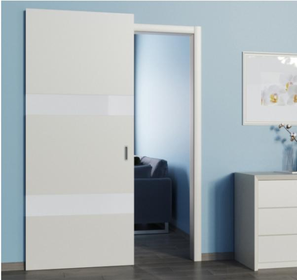
Эта система обеспечивает ход двери при открывании вдоль стены без каких-либо видимых направляющих, т.к. алюминиевая направляющая крепится не к стене, а к самому полотну, механизм с роликами на подшипниках с резиновым покрытием, для бесшумного и плавного скольжения находится на стене. Такие же ролики врезаются в нижний торец полотна.
